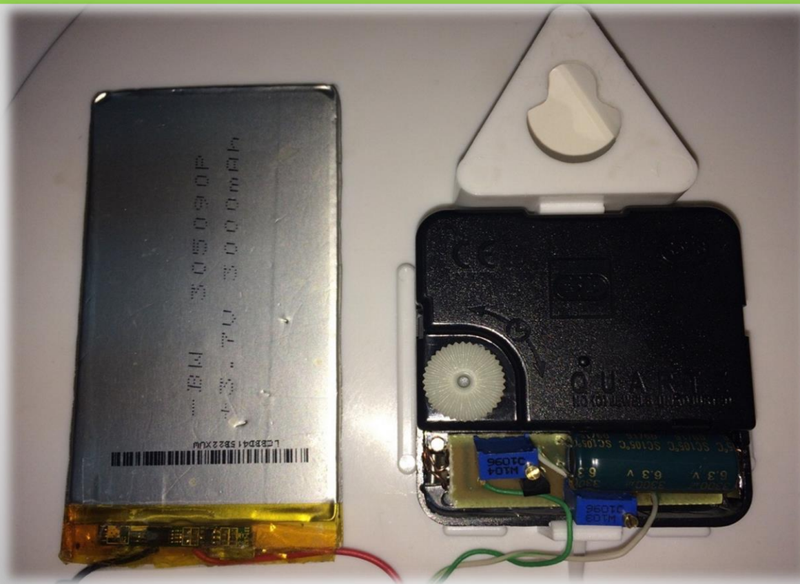
Микропотребляющий преобразователь напряжения для часовых механизмов
